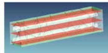
Figura 2: geometria del canale e delle sorgenti, visione 3D. Le superfici in rosso identificano i detector virtuali per la rilevazione dei raggi (top, middle, bottom det).
